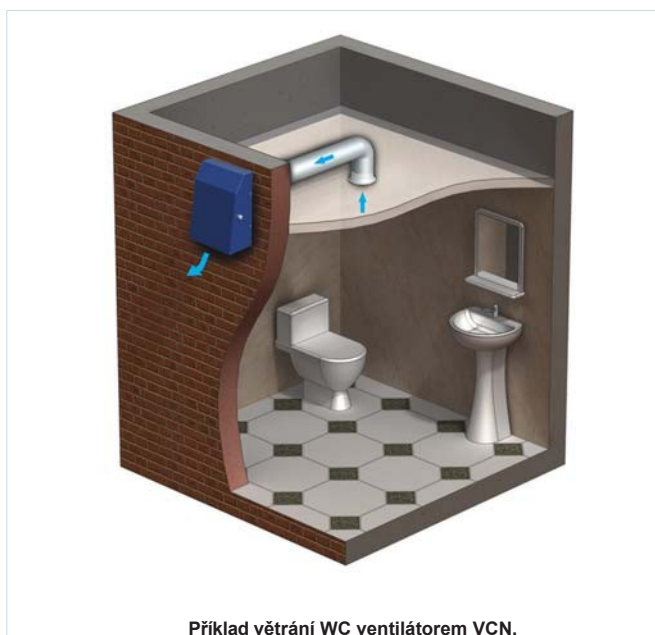
Příklad větrání WC ventilátorem VCN.
